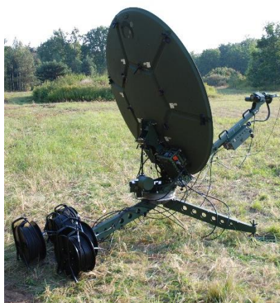
Rys. 8 SMART – terminal przewoźny klasy FlyAway.
