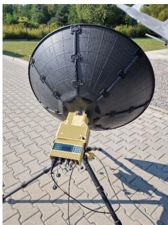
Rys. 5 SatPack COBALT – terminal z anteną paraboliczną centralną.
