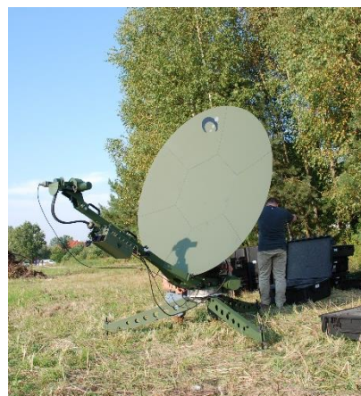
Rys. 6 SMART – terminal z anteną paraboliczną offsetową.
