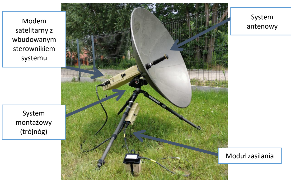
Rys. 1 SatPack COBALT - przedstawiciel rodziny modułowych terminali plecakowych klasy Manpack
