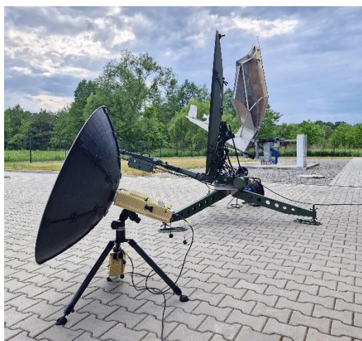
Rys. 2 Terminale do pracy z orbitą GEO – SatPack COBALT, SMART, stacja HUB-Master.
