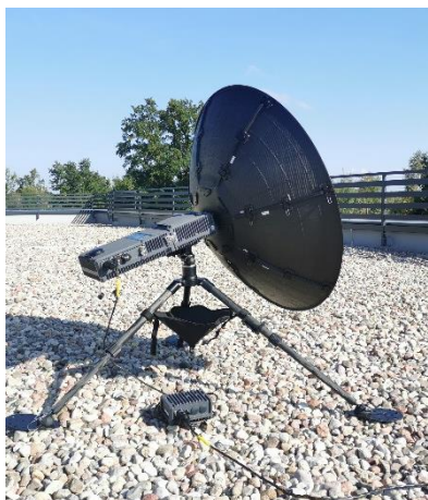
Rys. 7 SatPack COBALT – terminal plecakowy klasy MANPACK.
