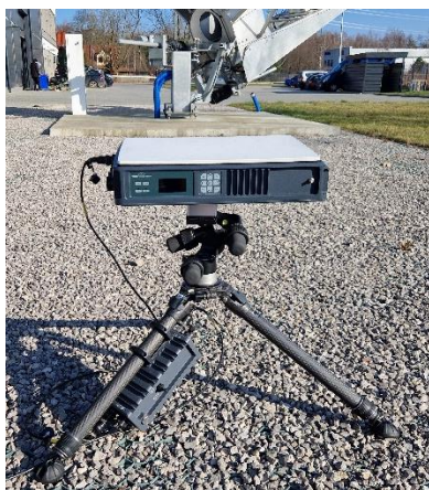
Rys. 4 Feniks – terminal z anteną płaską.
